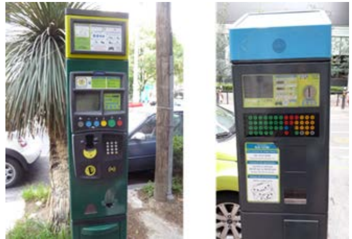
Ejemplos de parquímetros multi espacio
